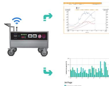
El FLUX DM - 200 toma el completo control de la bomba y el proceso de traspaso hasta completar la cantidad indicada por el usuario, luego de esto, detiene la bomba y cierra el proceso por sí mismo.
